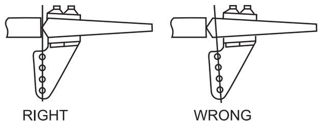
**INSTALLING THE AILERON LINKAGES**
