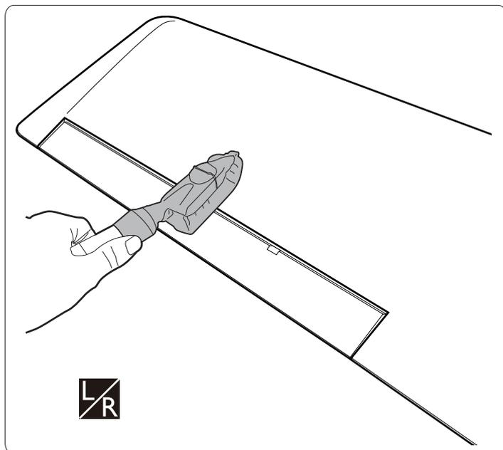
**INSTALLING THE AILERONS**
